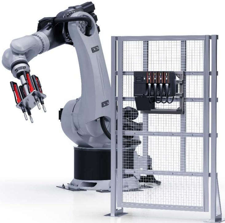
*Bei der Entwicklung der Multi-Schraubensysteme legte Desoutter sehr großen Wert auf die Sicherheit. Die Systeme sind so konzipiert, dass sie auch in Cobots eingesetzt werden können, bei denen Mitarbeiter eng mit Robotern zusammenarbeiten. (Bild: Desoutter)*
