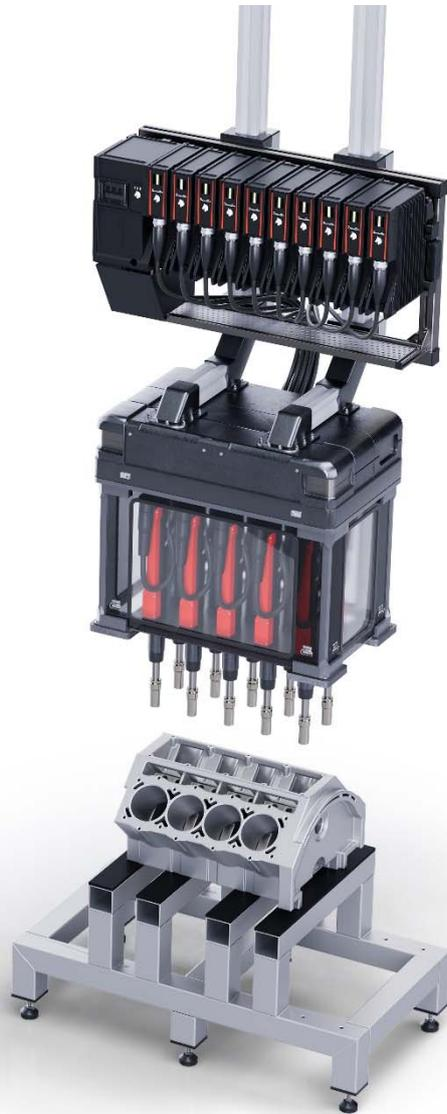
*Die Multi-Schraubensysteme von Desoutter unterstützen schlanke Montagelinien. Gegenüber anderen Systemen, erst recht mit Einzelwerkzeugen, sind für den Betrieb viel weniger Komponenten und Kabel erforderlich. In der Abbildung ein Beispiel mit einem Motorblock.
