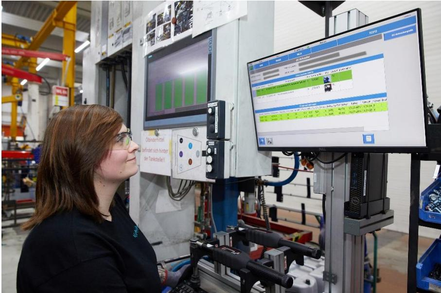
*(Bild D2031\_07...) Auf dem Bildschirm sieht die Mitarbeiterin, ob die letzten Verschraubungen in Ordnung waren (grün hinterlegt) oder nicht (rot). (Bild: Desoutter/Rüdiger Vogel)*
