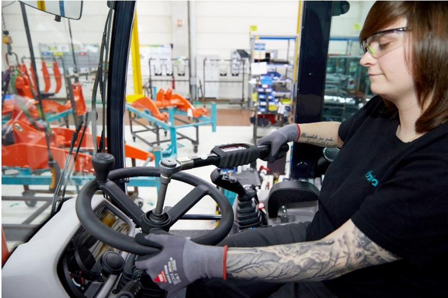
(Bild D2031\_03...) Die Lenkradmutter am Radlader wird mit einem Q-Shield auf 40 Nm angezogen. Die Verschraubung ist sicherheitsrelevant; das Drehmoment muss also kontrolliert und dokumentiert werden. Dazu kommuniziert der Drehmomentschlüssel über WLAN mit der übergeordneten IT von Kubota. (Bild: Desoutter/Rüdiger Vogel)
