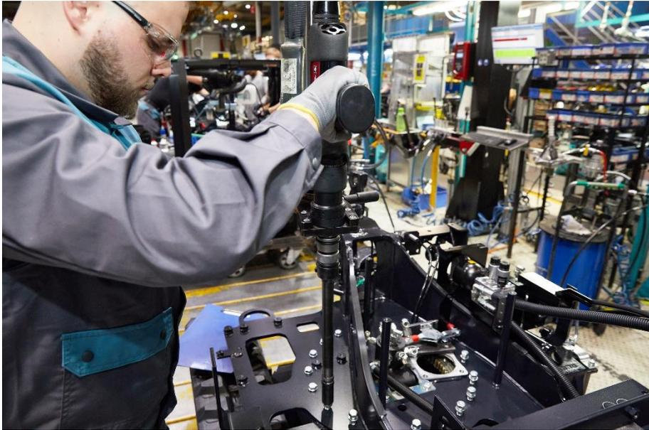
*(Bild D2031\_09...) Die Schrauben am Drehkranz der Bagger werden mit Drehmomenten von jeweils 300 Nm angezogen. Beim Anzug mittels ERP-Hochmomentschrauber von Desoutter wird der Drehwinkel überwacht. (Bild: Desoutter/Rüdiger Vogel)*
