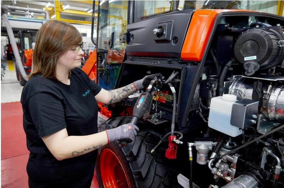
*(Bild D2031\_05...) Auch die Masseverschraubung am Motor-Hauptausschalter, mit der die Batterie abgeklemmt werden kann, wird mit einem Drehmomentschlüssel des Typs Q-Shield vorgenommen. Hier ist die Schraube mit 8,8 bis 11,8 Nm anzuziehen. Die Mitarbeiterin erhält ihr Feedback – ob die Verschraubung in Ordnung war oder nicht – einerseits durch die Vibration des Werkzeugs, auf dessen Display sowie zusätzlich auf dem Bildschirm über ihrem Arbeitsplatz. (Bild: Desoutter/Rüdiger Vogel)*
