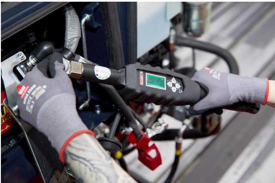
*(Bild D2031\_06...) Die Schraube am Batteriekabel muss mit einem Q-Shield auf 8,8 bis 11,8 Nm angezogen werden. Das Display des Drehmomentschlüssels zeigt hier 9,2 Nm an – damit ist die Masseverschraubung „i. O.“. (Bild: Desoutter/Rüdiger Vogel)*
