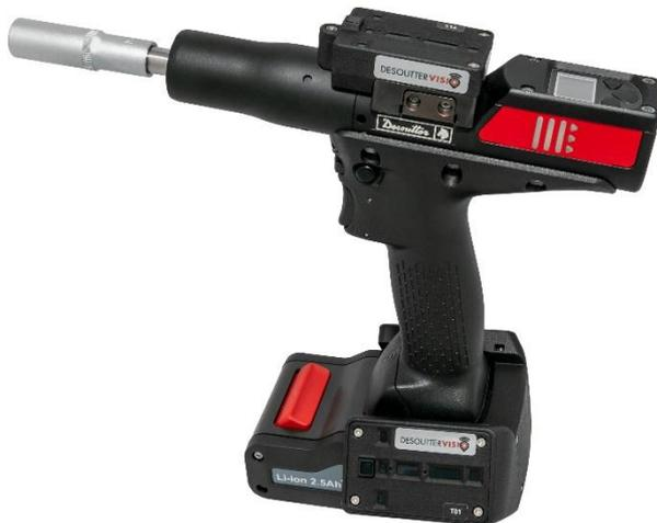
Wenn ein Desoutter-Akkuschrauber, wie hier im Bild, mit einem Transponder ausgerüstet ist, lässt sich das Werkzeug millimetergenau auf einer Schraube positionieren. Die Technik nennt sich Nexonar. Dahinter versteckt sich die rückverfolgbare Schraubmontage durch infrarotbasierte Tracking-Systeme, womit Fehler reduziert werden: Sollte der Mitarbeiter eine falsche Schraubstelle ansteuern, ließe sich das Werkzeug nicht starten. (Bild: Desoutter)
