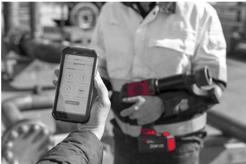
*Die CP86xx-Werkzeuge von Chicago Pneumatic können vom Smartphone aus überwacht und in der High-End-Ausstattung auch über das Handy programmiert werden. Eine Akkuladung hält bis zu 250 Verschraubungen durch. (Bild: Chicago Pneumatic)*
