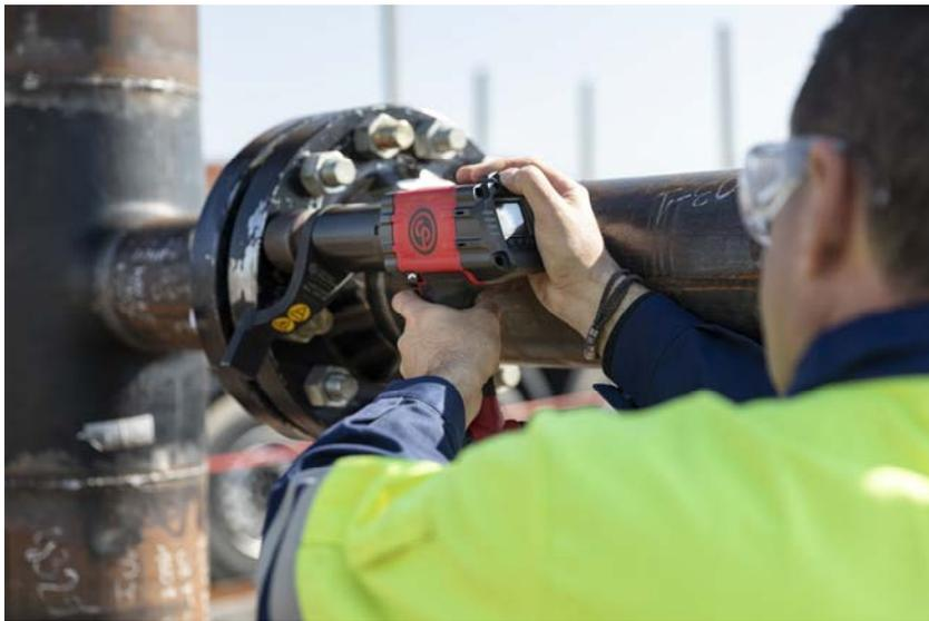
*Die Akku-Hochmomentschrauber der CP86er Serie von Chicago Pneumatic erzielen je nach Modell maximale Drehmomente zwischen 1300 und 8100 Nm. Sie eignen sich für die Instandhaltung von Raffinerieanlagen, Rohrleitungen oder auch Gasspeichern. (Bild: Chicago Pneumatic)*
