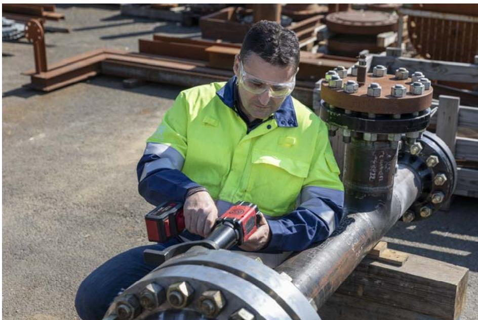
Mit ihren maximalen Drehmomenten, die je nach Modell zwischen 1300 und 8100 Nm liegen, eignen sich die Akku-Hochmomentschrauber der Serie CP86xx für die Instandhaltung von Windenergieanlagen und Raffinerieanlagen ebenso wie für Arbeiten an schweren Nutz- und Schienenfahrzeugen. (Bild: Chicago Pneumatic)
