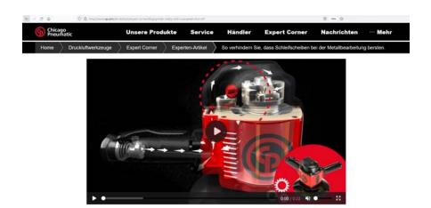
Zu einigen Themen stellt Chicago Pneumatic online auch kurze Experten-Videos zur Verfügung. In diesem Video wird etwa erklärt, wie der automatische Überlastschutz einer Schleifmaschine funktioniert. (Bild: Chicago Pneumatic)
