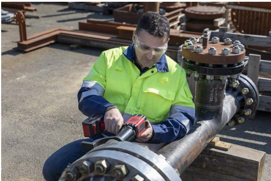
*Die neuen Hochmomentschrauber von Chicago Pneumatic wurden für Anwender entwickelt, die eine hohe Präzision bei der Montage mit der Flexibilität eines Akkuschraubers verbinden wollen. Mit ihren maximalen Drehmomenten, die je nach Modell zwischen 1300 und 8100 Nm liegen, eignen sie sich für die Instandhaltung von Windenergieanlagen und Raffinerieanlagen ebenso wie für Arbeiten an schweren Nutz- und Schienenfahrzeugen. (Bild: Chicago Pneumatic)*
