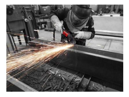
Mit den neuen Druckluft-Schleifmaschinen der CP3750er Serie wendet sich Chicago Pneumatic an Kunden, die ihre Produktivität mit begrenztem Budget steigern wollen. Anwendungen liegen im Maschinenbau, in Gießereien und Werften, im Schienenfahrzeugbau sowie in Handwerk und Werkstätten. Mit den leistungsstarken Schleifern können alle gängigen Werkstoffe bearbeitet werden. (Bild: Chicago Pneumatic)
