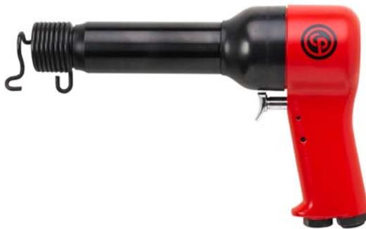
*Der kräftige Niethammer CP4287 von Chicago Pneumatic eignet sich für 7X-Anwendungen im Flugzeugbau mit Niet-Durchmessern bis zu 5/16" bei Alu-Nieten oder 1/4" bei Stahl-Nieten. (Bild: Chicago Pneumatic)*
