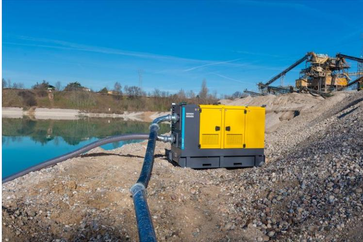
*Die trocken aufgestellten Entwässerungspumpen vom Typ PAS sind auf hohe Leistung, Zuverlässigkeit und einfache Bedienung ausgelegt. Sie werden für die Entwässerung von Baustellen, Bergwerken und im Tagebau, zur Hochwasserbeseitigung sowie für viele andere öffentliche Anwendungen eingesetzt, etwa im Zivilschutz. (Bild: Atlas Copco)*
