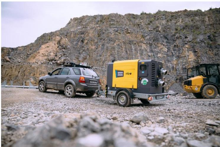
*Atlas Copco hält Pumpen für unterschiedliche Fördervolumina und Anforderungen bereit. Die Modelle reichen von der kleinen tragbaren Motorpumpe über Aggregate, die sich auf einen kleinen Anhänger setzen lassen, bis hin zu großen Entwässerungslösungen. (Bild: Atlas Copco)*
