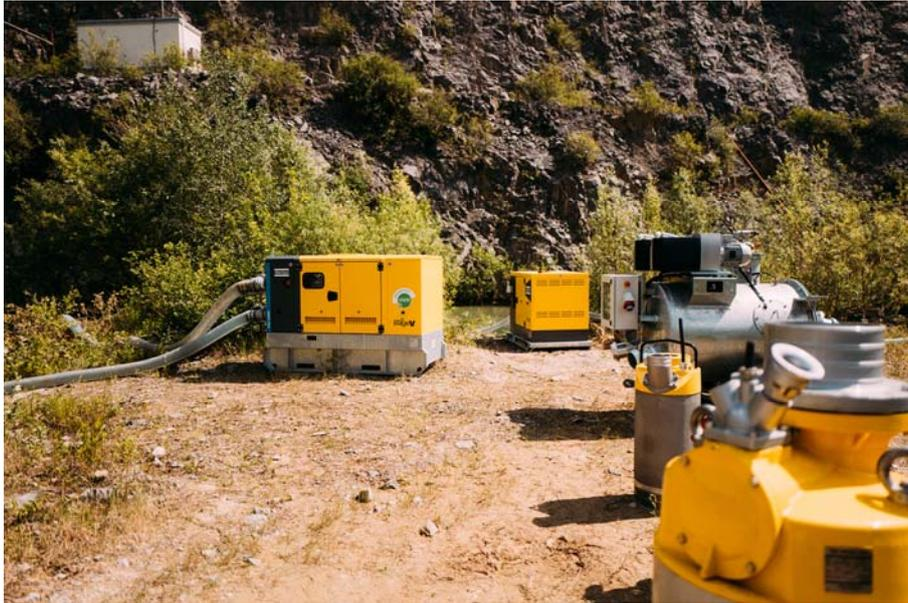
*Die trocken aufgestellten Entwässerungspumpen vom Typ PAS (hinten links) sind auf hohe Leistung, Zuverlässigkeit und einfache Bedienung ausgelegt. Sie werden für die Entwässerung von Baustellen und Bergwerken, die Hochwasserbeseitigung sowie für andere öffentliche Anwendungen eingesetzt. Die große PAS 300 bewältigt Förderströme von maximal 2100 m<sup>3</sup> pro Stunde. (Bild: Atlas Copco)*
