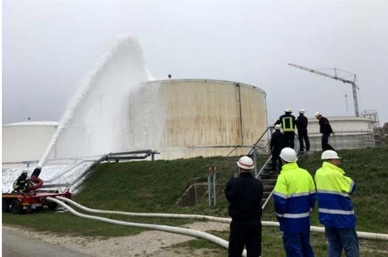
*Die Schaumlöschanlagen von MicroCAFS erreichen mit einer speziellen Technologie bei den Durchflusswerten ein ganz neues Niveau für das Löschen von Industriebränden. Das derzeit größte System fördert bis zu 32000 Liter Schaumgemisch pro Minute. (Bild: MicroCAFS)*
