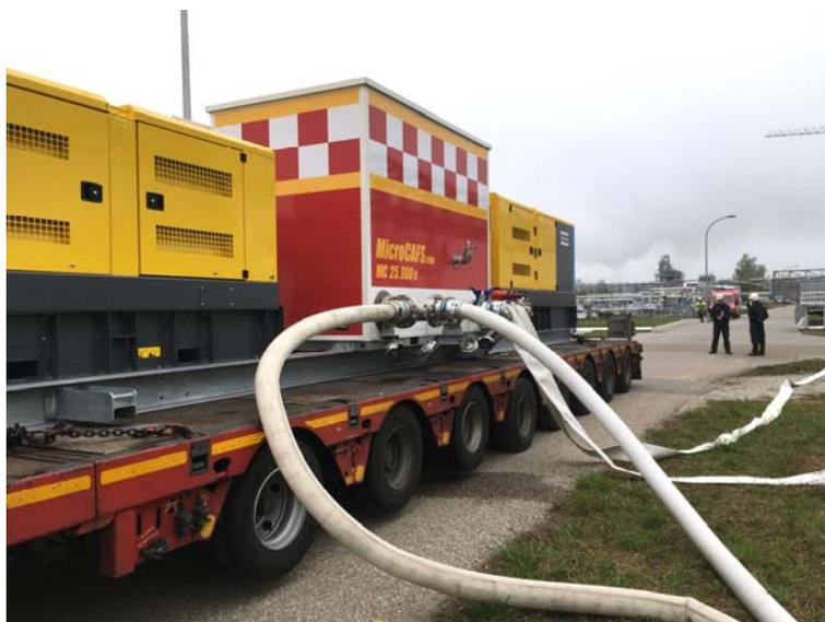
*Für mobile Löschanlagen, wie sie etwa von Werkfeuerwehren auf großen Raffineriegeländen benötigt werden, ist die Orts-Unabhängigkeit wichtig. In diesen Fällen wird die MicroCAFS-Anlage um einen Atlas-Copco-Generator des Typs QAS 325 ergänzt (rechts auf dem Auflieger). Im Einsatzfall kann er den für den Kompressor benötigten Strom erzeugen. (Bild: MicroCAFS)*
