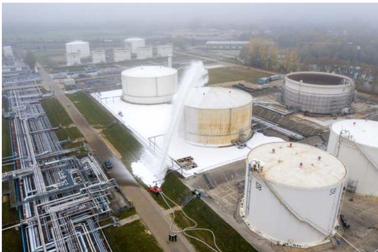
*Die Druckluftschaumanlagen von MicroCAFS setzen dem Schaum-Wasser-Gemisch noch Druckluft hinzu. Das führt zu einer besseren Schaumqualität – und die in der Druckluft gespeicherte Energie verleiht dem Gemisch zusätzlichen Schub, der zu einer hohen Reichweite der Schaumkanone von derzeit bis zu 80 m führt. (Bild: MicroCAFS)*
