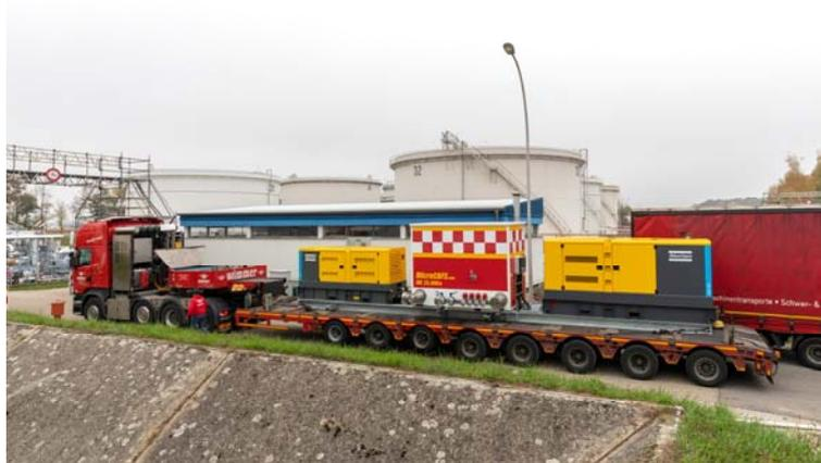
*Ein wichtiger Bestandteil der Druckluftschaumanlage ist der Atlas-Copco-Elektrokompresseur E-Air 900T (links auf dem Anhänger). Er erzeugt die Druckluft, mit der das Schaummittel gemischt wird, um über einen Werfer als Löschschaum ausgeschossen werden zu können. Das Aggregat ist um bis zu 50 % kleiner und bis zu 30 % leichter als die meisten vergleichbaren Kompressoren. (Bild: MicroCAFS)*
