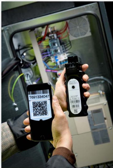
Mittels eines QR-Codes können Maschinen online registriert und in Smartlink 2.0 integriert werden. (Bild: Atlas Copco)
