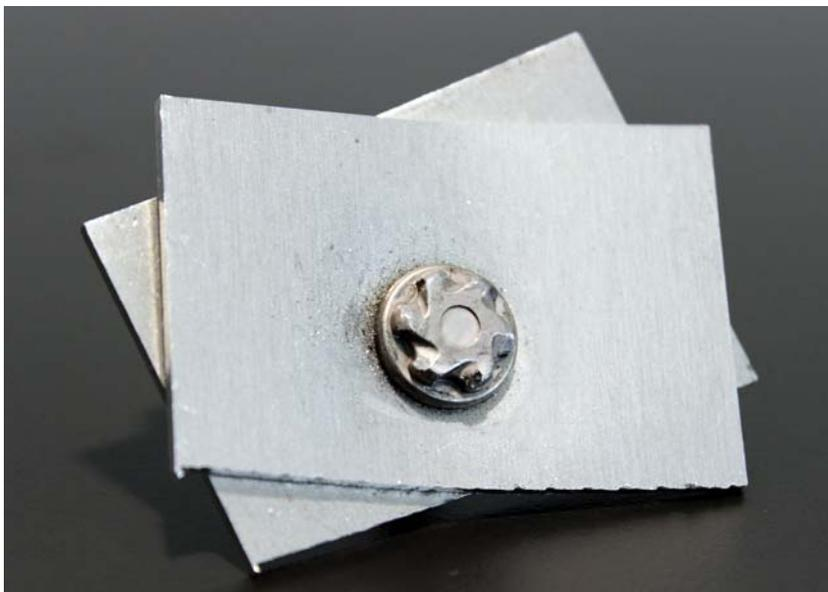
*Manche Fehler können leicht aufgedeckt werden: Lässt sich das Fügeelement – wie hier – von Hand bewegen, können lockere Bleche oder Teile die Folge sein (wenn kein Klebstoff verwendet wird). (Bild: Atlas Copco)*
