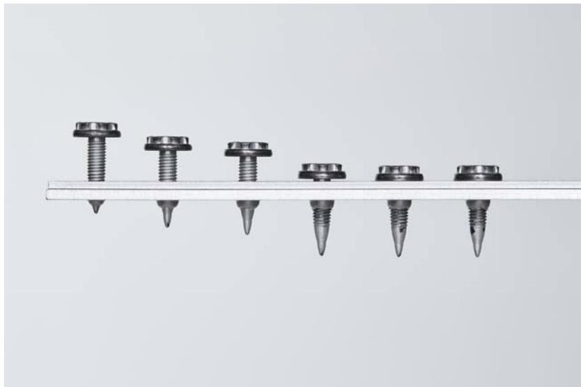
*Eine Fließblochschaube verbindet mehrere Materialien. Sie ist dabei gleichzeitig Bohr- und Verbindungselement. Das Fügeelement wird bei hoher Drehzahl und unter Druck durch alle Materiallagen gedrückt und formt dabei das Gewinde. (Bild: Atlas Copco)*
