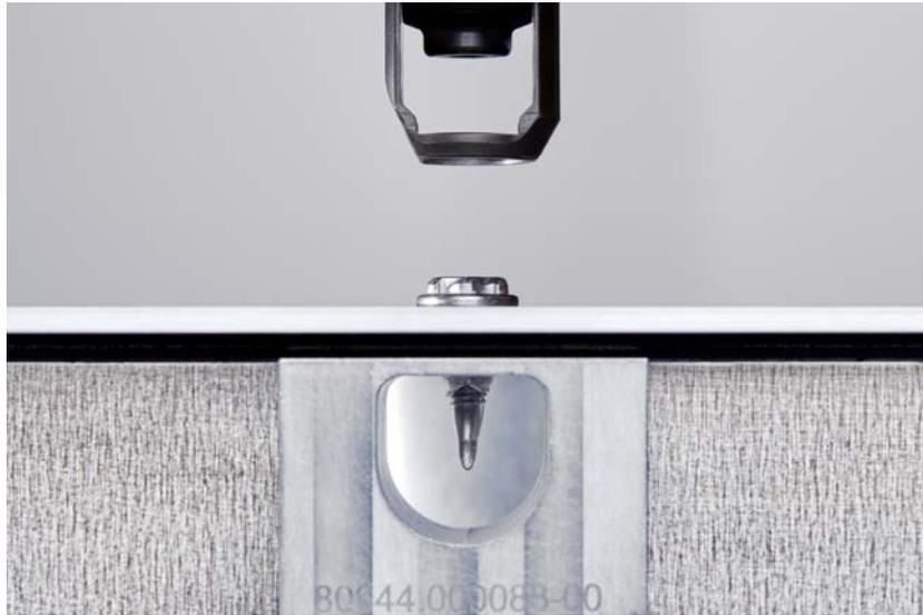
*Mit Fließblochsrauben können Multi-Material-Verbindungen hergestellt werden. Diese Füge-technik eignet sich vor allem für Anwendungen, bei denen die Schraubstelle nur von einer Seite zugänglich ist. (Bild: Atlas Copco)*
