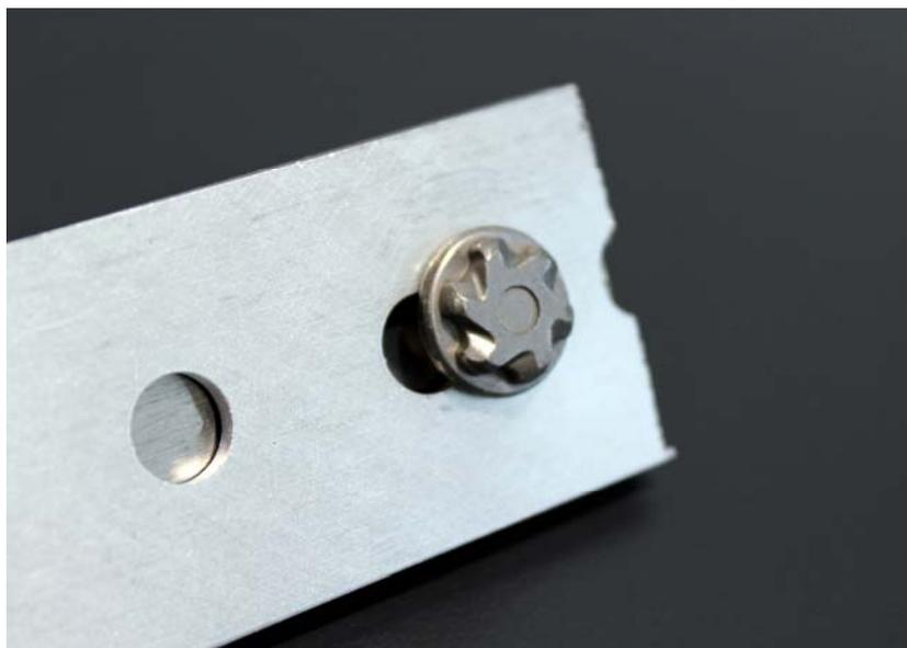
*Die Fließblochschaube muss die Durchgangsbohrung vollständig abdecken. Das ist hier nicht der Fall. (Bild: Atlas Copco)*
