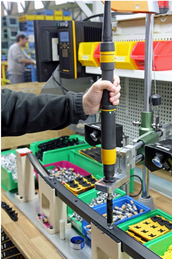
Elektrische Tensor-ES-moeraanzetter, ergonomisch ingespannen in een lineaire eenheid die het reactiekoppel opvangt. Op de achtergrond (bovenaan centraal op de foto) de moeraanzetterbesturing Power Focus 600. (Foto: Atlas Copco Tools)
