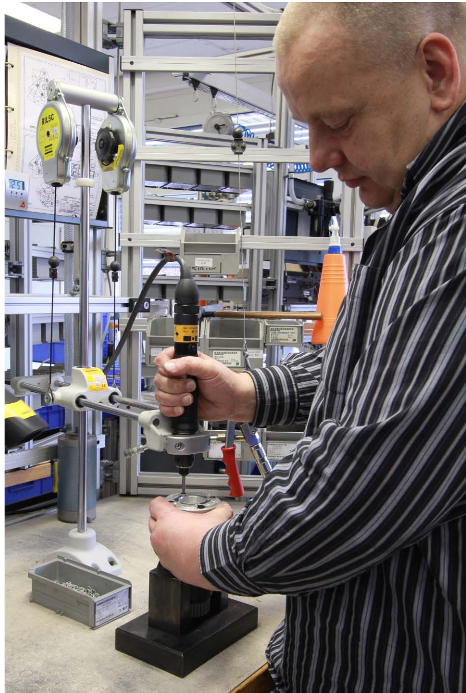
Op een ander station wordt de motorflens met een enkele moeraanzetter gemonteerd. (Foto: Atlas Copco Tools)
