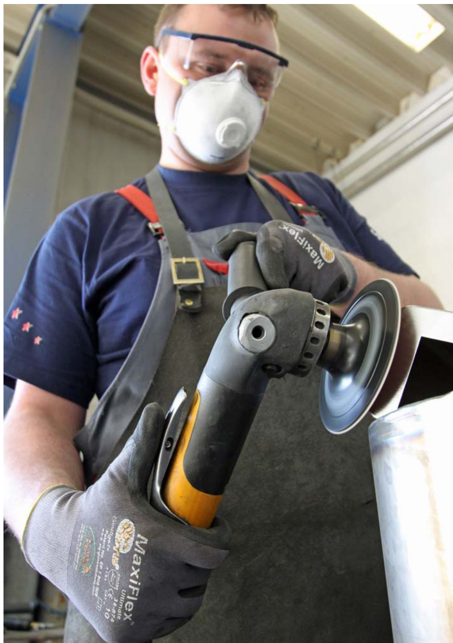
Jordan Blechworxx zet Atlas Copco machines in voor het bewerken van lasnaden, schuren van aluminium- en stalendelen voor het poedercoaten, frees- en afbraamwerkzaamheden en voor alles reinigen van structuren van edelstaal oppervlakken. (Foto: Atlas Copco Tools)
