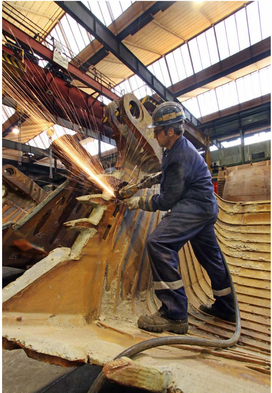
Na vele jaren gebruikt te zijn was dit scheprad versleten. Met de turboslijper GTG 40 krijgt ze een verjongingskuur. (Foto: Atlas Copco Tools)
