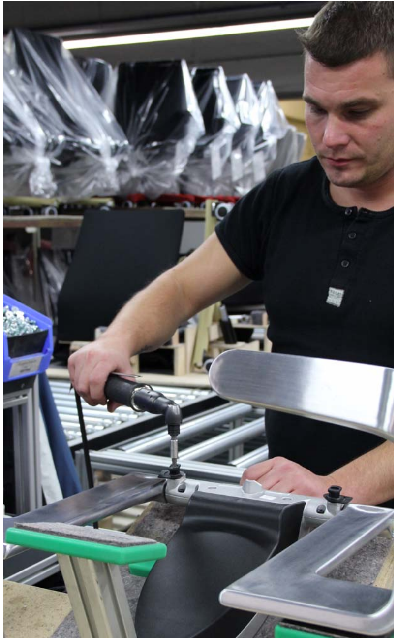
Montage van de beide schroeven met de zelfde machine aan het „kniegewricht“, waarbij geen gradiëntstrategie nodig is. (Foto: Atlas Copco Tools)
