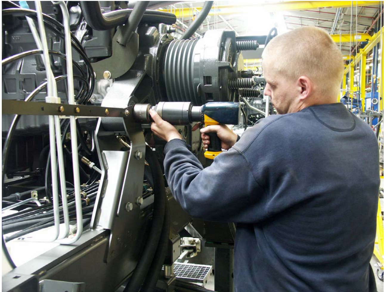
Om de motorsteun te fixeren worden de moeren met 1300 Nm aangetrokken. (Bron: Atlas Copco Tools)
