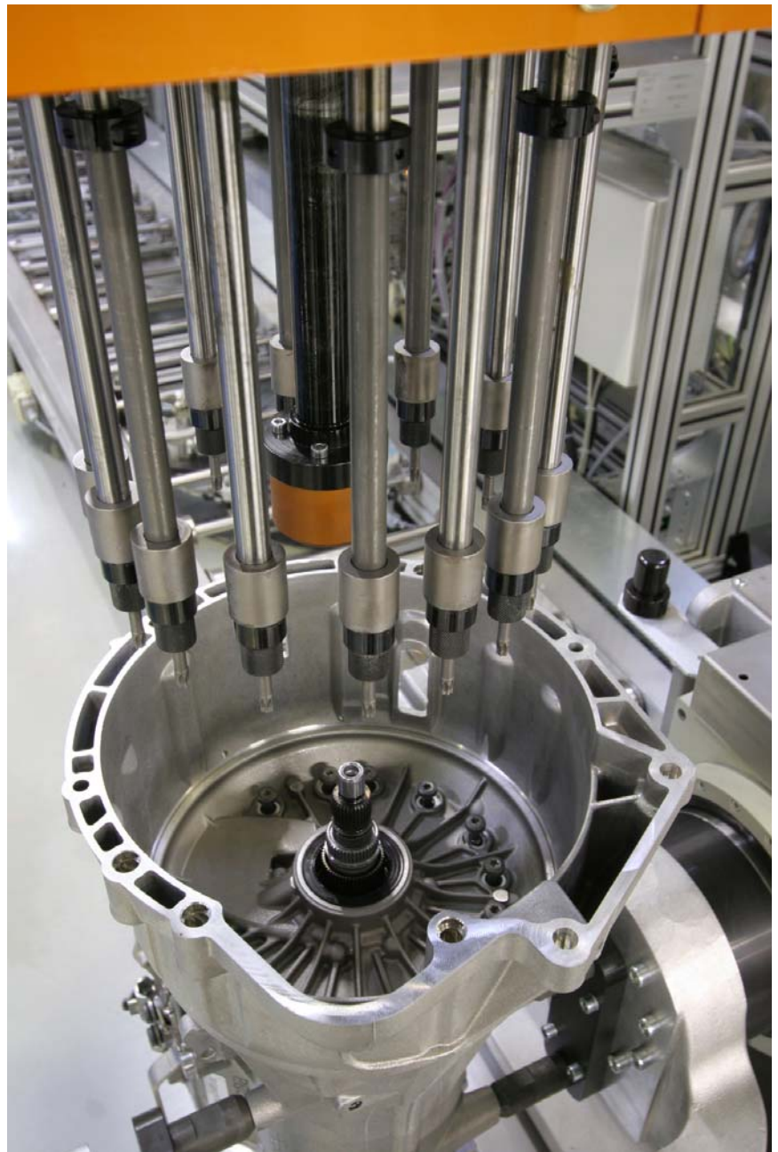
Montage met de 14-voudige multispindel van bovenaf in het aandrijfhuis. (Foto: Atlas Copco Tools)
