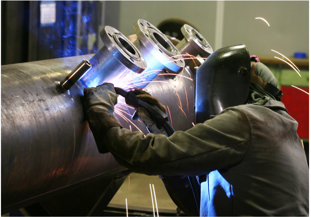
Laswerkzaamheden domineren de straalpomp- en apparatenbouw bij Körting. (Bron: Atlas Copco Tools)
