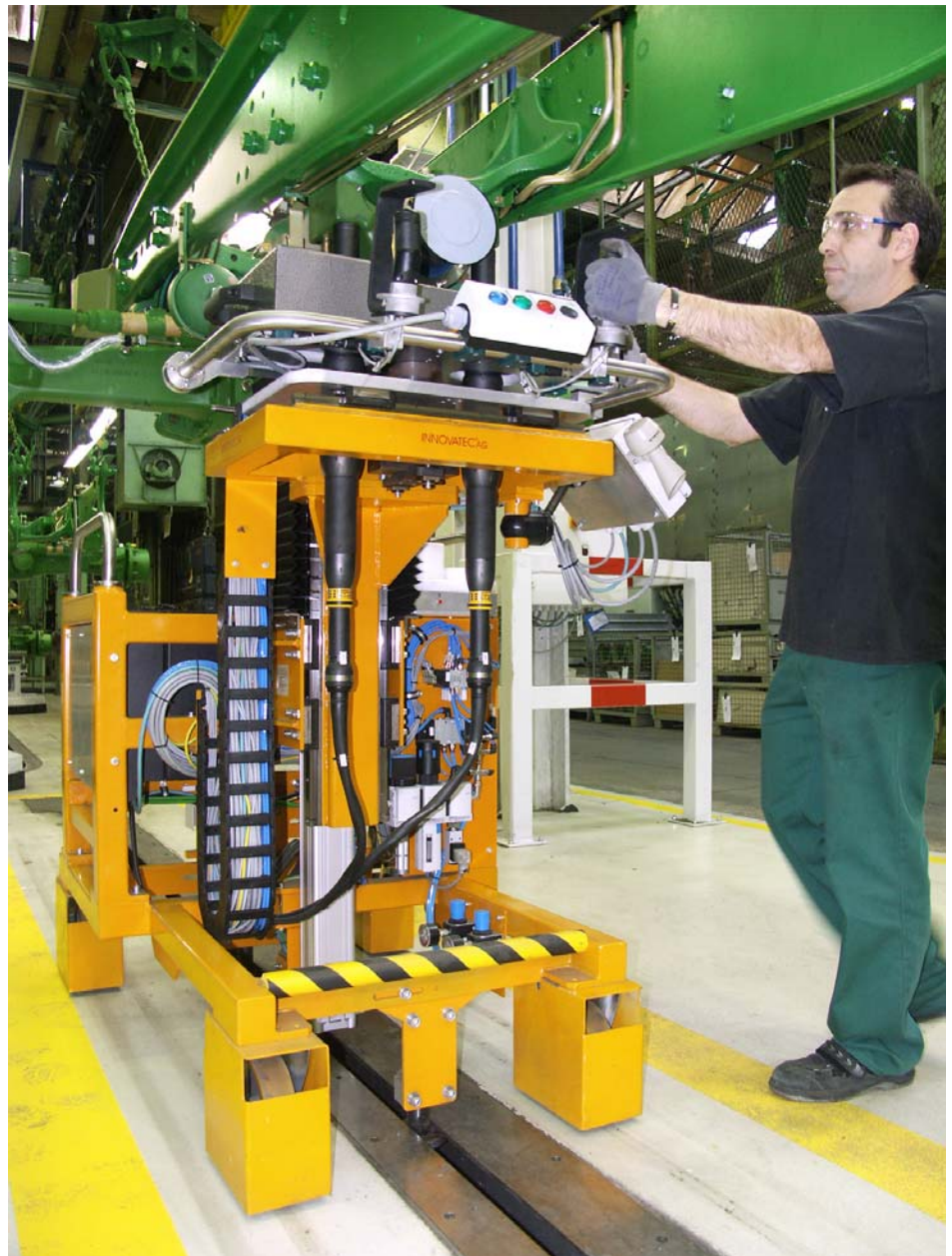
Hier wordt gemonteerd. Het tractorchassis zweeft aan monorails, het montagesysteem wordt van onder aan de wagen aangevoerd. (Foto: Atlas Copco Tools)
